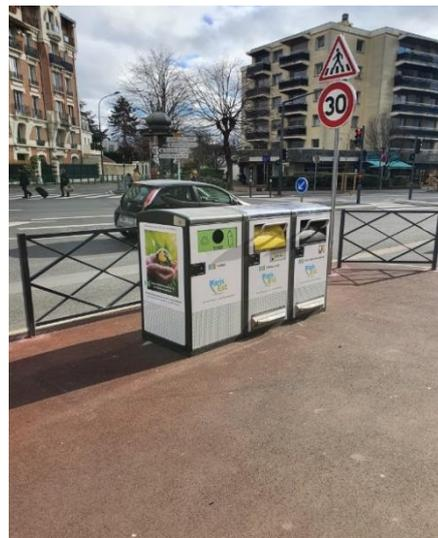
La corbeille est entièrement autonome, grâce à son panneau solaire et sa carte sim, qui communique à distance. Le nombre d'ouverture de porte, le pourcentage de remplissage du contenant et les moindres dysfonctionnements, nous parviennent sur un logiciel avec cartographique, grâce à la géolocalisation de chaque appareil.
