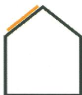
Tout comme le fenêtrage ou la porte, le capteur doit être considéré comme un élément de composition architecturale. Il doit donc être intégré dans l'ordonnancement d'une toiture, d'un volume. L'implantation se fera en suivant la pente de la toiture. Il ne sera pas utilisé de supports permettant d'incliner le capteur et le rendant plus visible.
